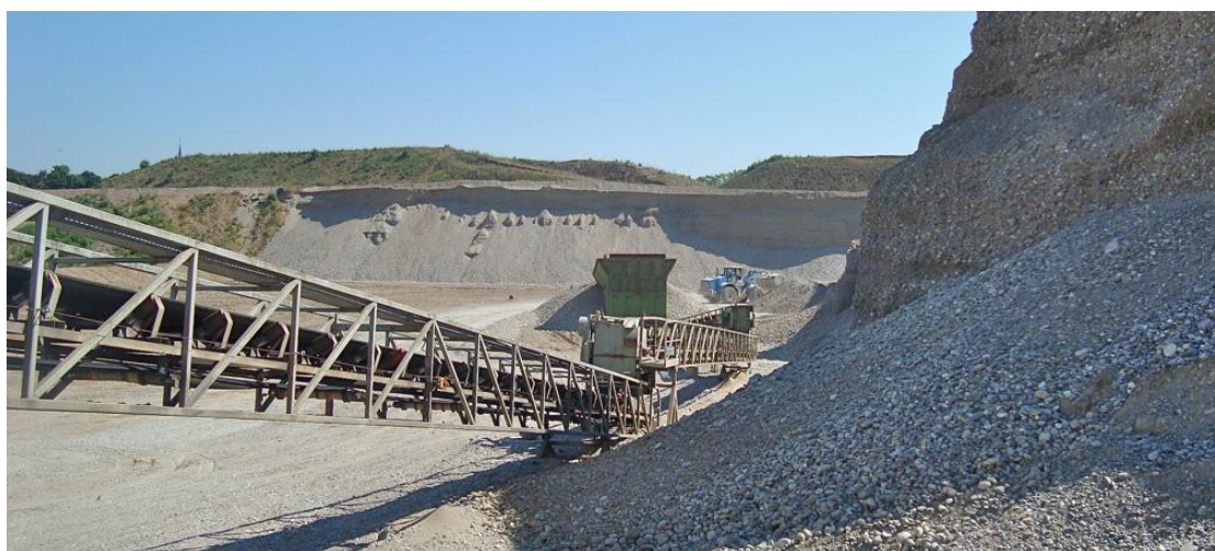
2- Ci-dessus : Le gravier est extrait en plusieurs étapes, jusqu'à une profondeur d'environ 15 mètres.
